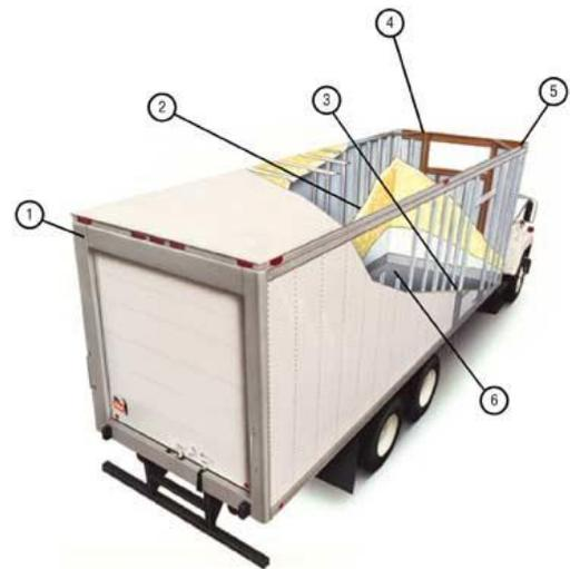
Imagen 24. Elementos de transporte refrigerado.
